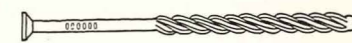
Søm til gulvlægning. Leveres i varmebehandlet kulstofstål (til blødt træ leveres de i alm. stål.) Spiralgevindtet forøger sømets modstand mod udtrækning.
